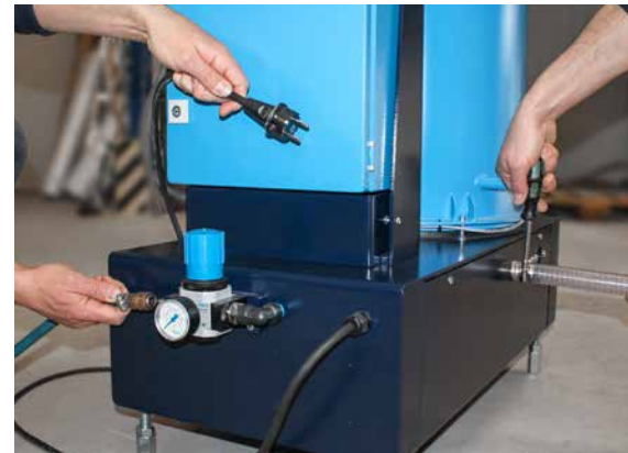
Conexiones del aire comprimido, el suministro eléctrico y el tubo de transporte
